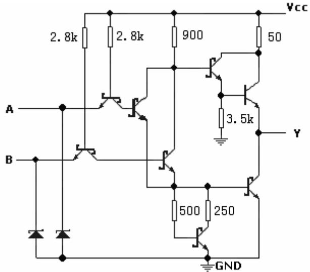
逻辑式:  $Y=\overline{A+B}$  或  $Y=\overline{A}\cdot\overline{B}$
