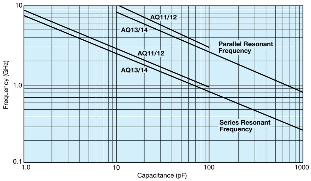
TYPICAL RESONANT FREQUENCY vs. CAPACITANCE
